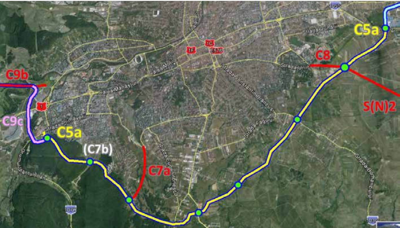
Construcția unui drum cu două benzi pe sens, separator median, intersecții denivelate și acces integral controlat, de 14 km, între vestul orașului (DJ 107R în zona Bucium) și estul orașului (DJ 105S est de Selgros), ocolindu-l prin sud.
